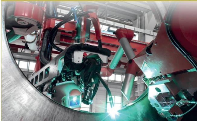
и внутренние поверхности деталей, недоступные для ручной сварки, в различных пространственных положениях.
