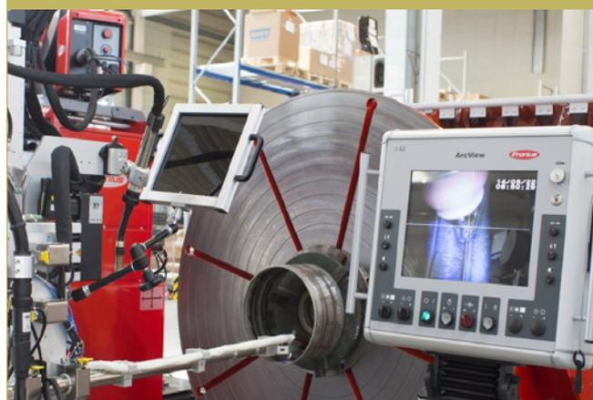
**Рис. 3. Многофункциональная сварочная головка от Fronius**
